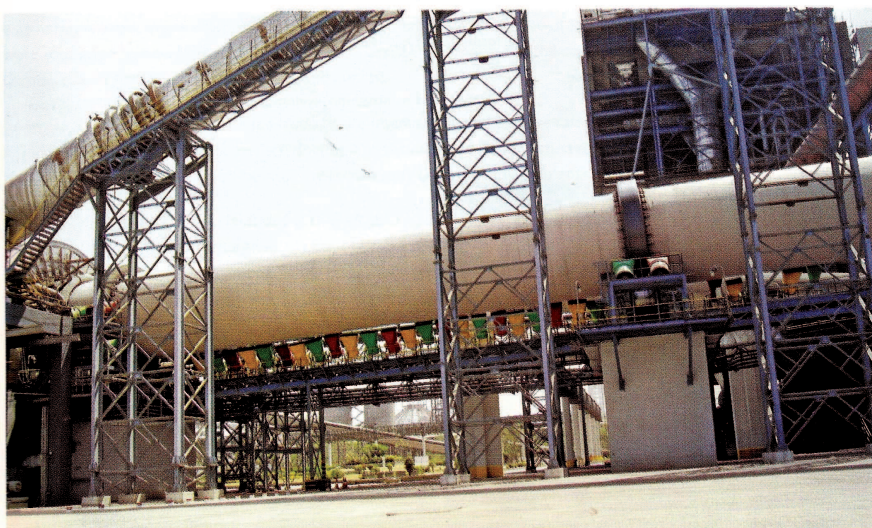
Rys. 4. Największy na świecie piec w cementowni w Wadi, Karnataka, w Indiach; średnica 6m, długość 96 m, 6-stopniowy, dwustrumieniowy wymiennik cyklonowy z dekarbonizatorem.
